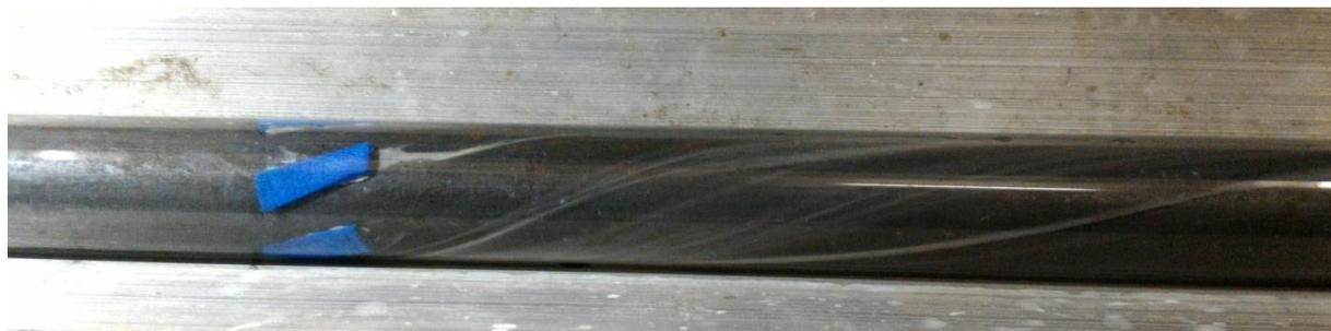
**Рисунок 7. Турбулизация потока жидкости после прохождения центрирующего-турбулизатора.**
