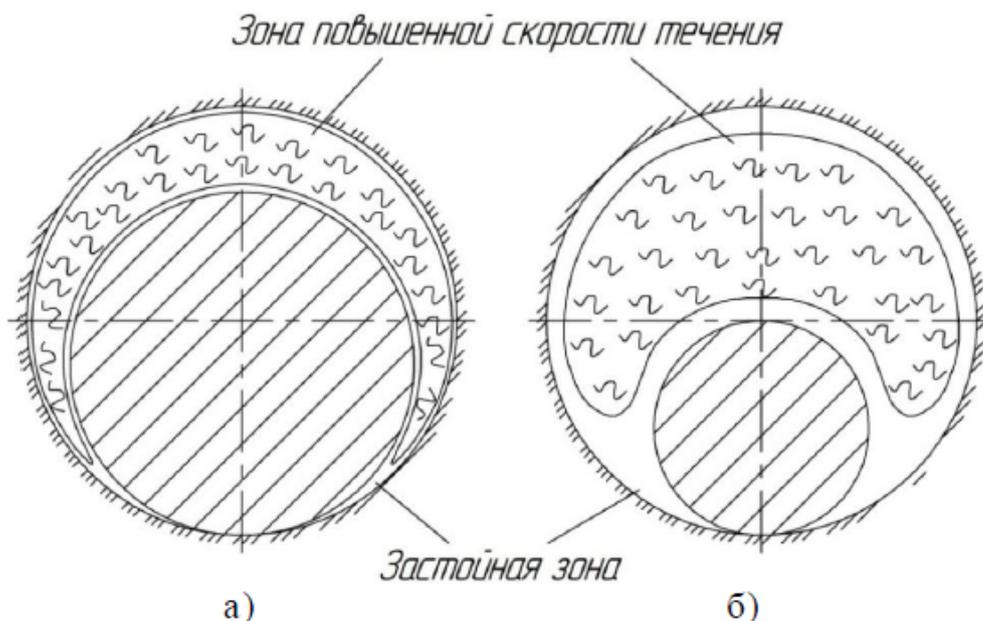
**Рисунок 2. Распределение скорости течения жидкости в кольцевом пространстве**
