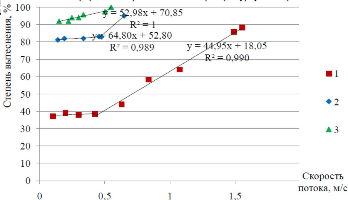
**Рисунок 6. Влияние скорости потока жидкости на степень вытеснения бурового раствора тампонажным при  $d/D = 0,89$ , где: 1 – обсадная колонна лежит на нижней стенке скважины, 2 – обсадная колонна отцентрирована прямым центратором, 3 – обсадная колонна отцентрирована с применением центратора турбулизатора**
