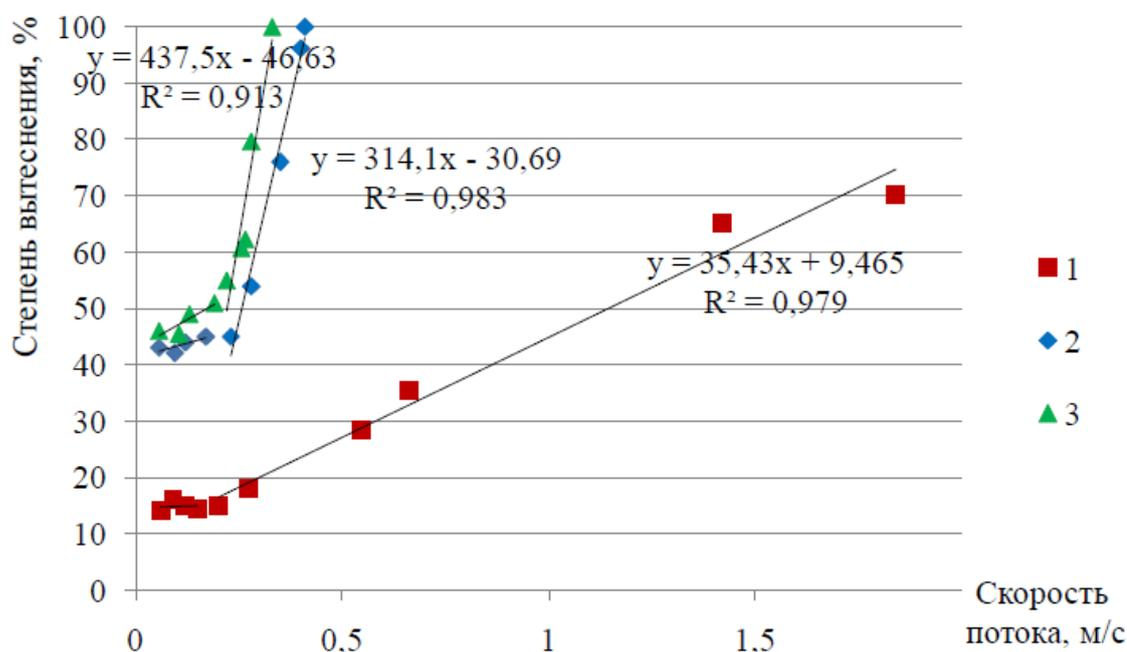
**Рисунок 3. Влияние скорости потока жидкости на степень вытеснения бурового раствора тампонажным при  $d/D = 0,56$ : 1 – обсадная колонна лежит на нижней стенке скважины, 2 – обсадная колонна отцентрирована прямым центратором, 3 – обсадная колонна отцентрирована с применением центратора турбулизатора**
