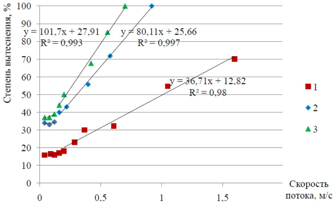
Рисунок 4. Влияние скорости потока жидкости на степень вытеснения бурового раствора тампонажным при  $d/D = 0,67$ : 1 – обсадная колонна лежит на нижней стенке скважины, 2 – обсадная колонна отцентрирована прямым центратором, 3 – обсадная колонна отцентрирована с применением центратора турбулизатора
