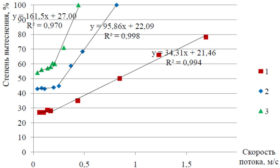
Рисунок 5. Влияние скорости потока жидкости на степень вытеснения бурового раствора тампонажным при  $d/D = 0,78$ : 1 – обсадная колонна лежит на нижней стенке скважины, 2 – обсадная колонна отцентрирована прямым центратором, 3 – обсадная колонна отцентрирована с применением центратора турбулизатора
