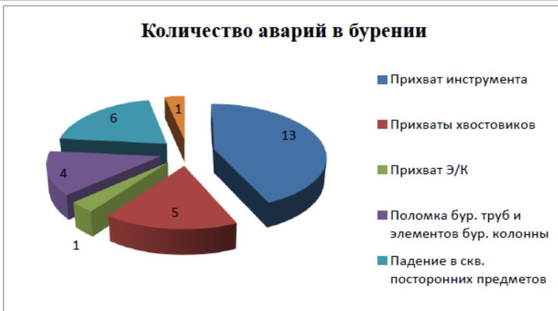
**Рисунок 2 - Аварии на Самотлорском месторождении при бурении новых скважин за 2015 год**
