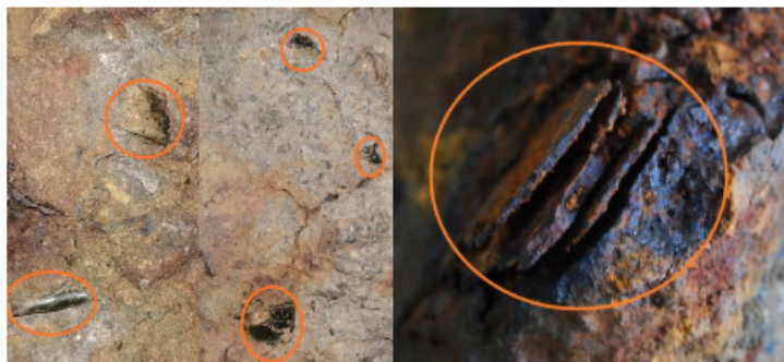
Рисунок 5. Частицы оливина (слева) и пластинчатое расслоение окисленной металлической матрицы в исследуемом теле (справа).
