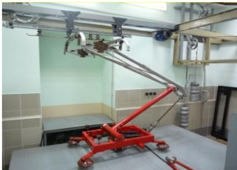
Рис. 2. Кинематическая схема ударно-колебательной установки для испытаний токоприемников (а) и ее внешний вид (б)
