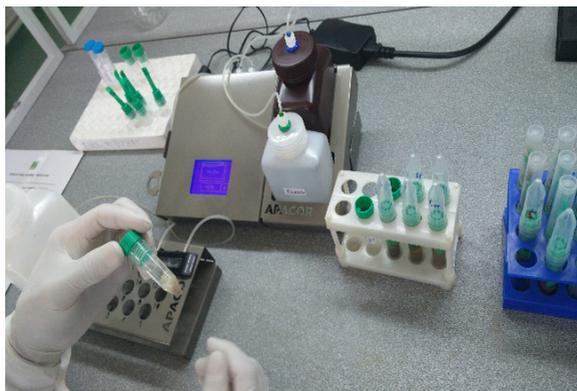
*Рис. 3 – Исследование на системе «Parasys» для сбора и обработки паразитов в образцах кала*
