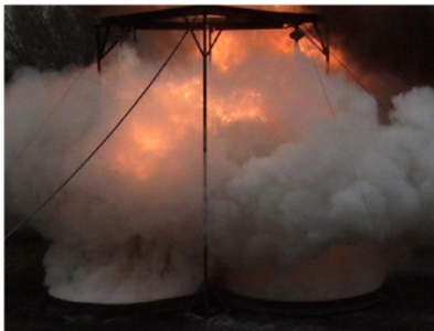
Рисунок 1 – Видеокадры испытаний по тушению сложного очага пожара
