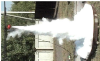
Рисунок 2 – Видеокадры испытаний по взаимодействию факела расплывающегося порошка с поверхностью жидкости
