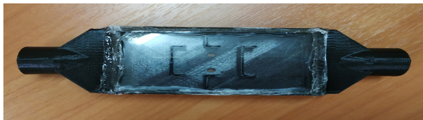
Рис. 3. Фотография П-образного сепаратора, предназначенного для разделения эмульсий
