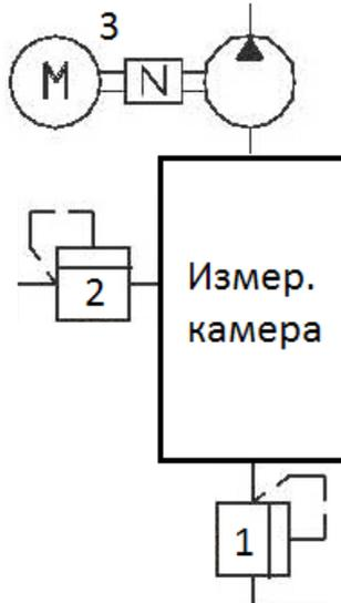
*Рисунок 2 – Предлагаемая гидравлическая схема измерительной камеры*
