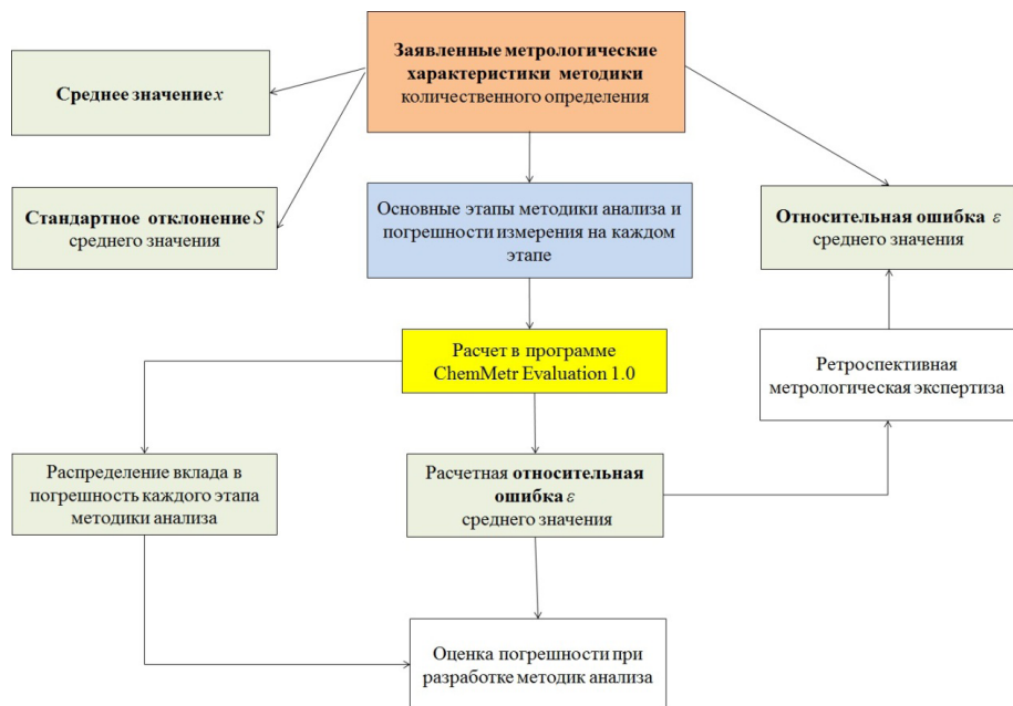
Рисунок – Алгоритм применения компьютерной программы «ChemMetr Evaluation 1.0» в судебно-химической экспертизе и фармацевтическом анализе
