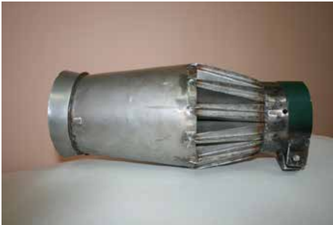
Рис. 7. Эжекторные насадки для: а – ВАЗ 2106, б – Ока, в – мотодикл, г – городской автобус «Икарус», д – речной буксир, е – трактор «Беларусь 2022»
