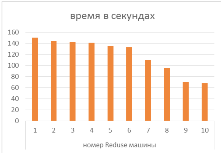
Рис.2 – Временные затраты на выполнения задачи Reduce Эта гистограмма показывает сколько секунд выполнялось Reduce задача на каждом из узлов кластера. Все Reducer -ы на гистограммах (рис.1 и рис.2) отсортированы по убыванию времени выполнения Reduce задачи
