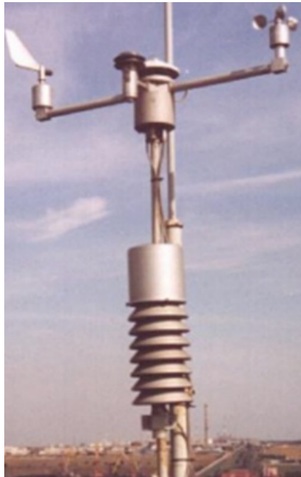
Рис. 3. Автоматическая метеорологическая станция, осуществляющая сбор и передачу метеорологических данных
