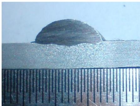
*Рисунок 4 - Поперечное сечение валика, выполненного пучком из трех электродов*
