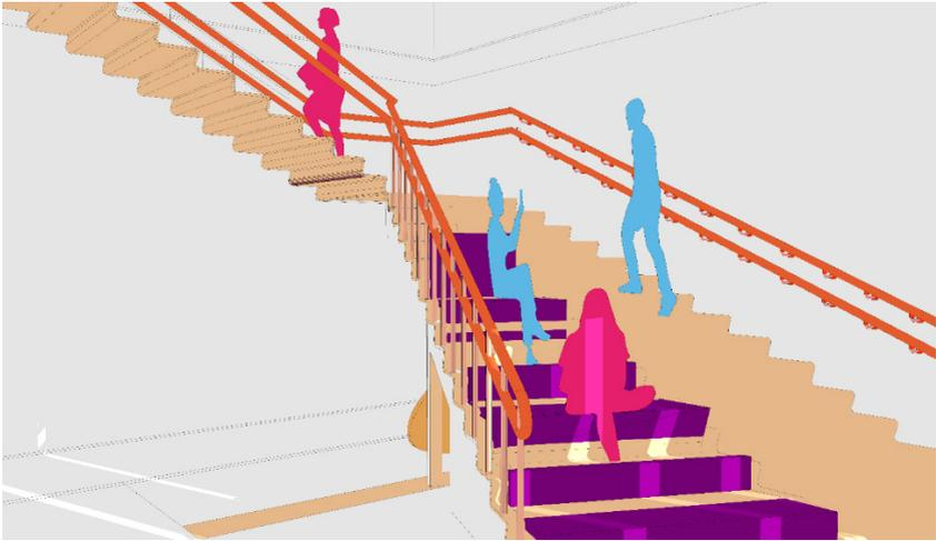
*Рис. 2. Конфигурация лестницы, модифицированные выделенные места под «сидячие» ступени и фрагменты перилл*
