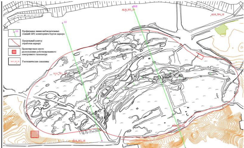
Рисунок 2 - Схема расположения профильных линий за наблюдением устойчивости западного борта карьера
