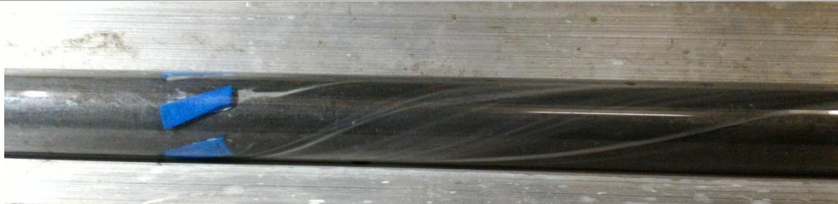
**Рисунок 7. Турбулизация потока жидкости после прохождения центриатора-турбулизатора.**
