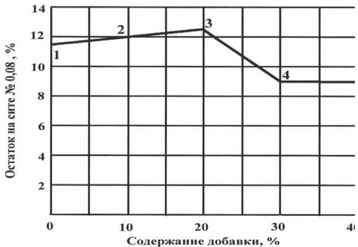
Рис. 2. Зависимость степени измельчения добавочных цементов от содержания золошлаковой смеси сухого удаления
