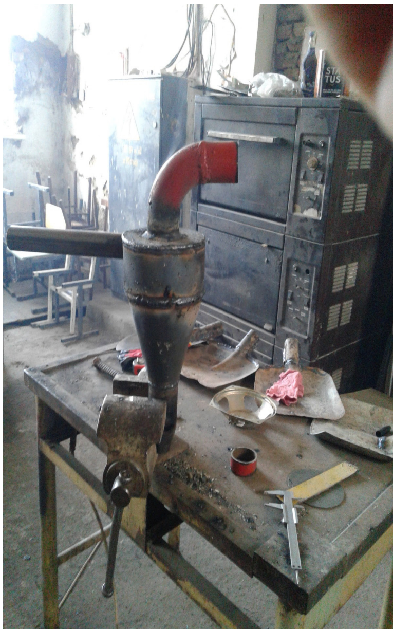
Рис. 3. Процесс изготовления конструкции гидроциклона
