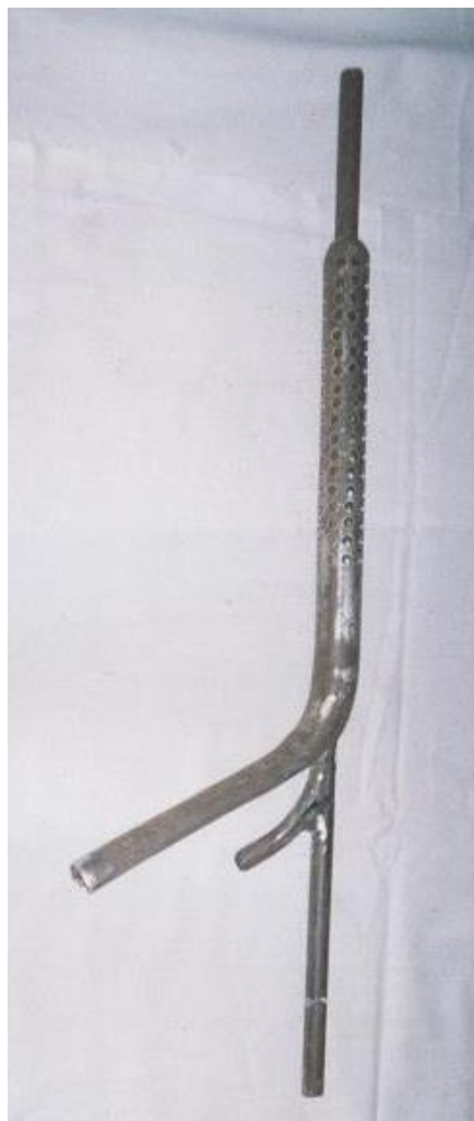
Рис. 1. Ловушка легкой фазы – перфорированная трубка с гидроэлеватором для тяжелой фазы и эжектором для легкой фазы
