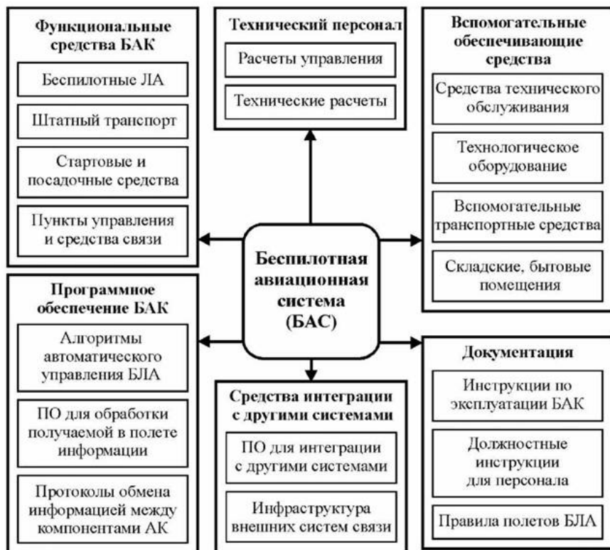
Рис. 1 Обобщенная структура БАС
