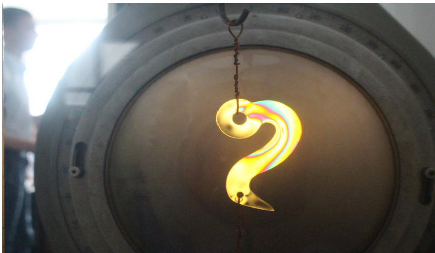
Рисунок 2 – Модель крюка в поле полярископа (источник белого света)
