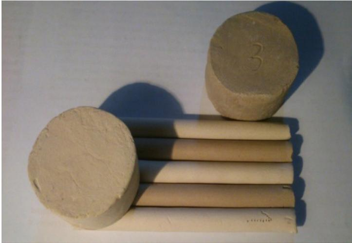
**Рисунок 1.** Образцы высоковольтных керамических материалов выполненных в виде цилиндрических стержней (диаметр 4,5 см и высотой 3 см).
