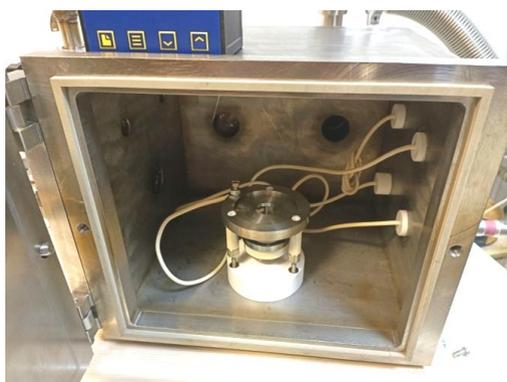
**Рисунок 5** – Установка магнетрона в рабочей камере
