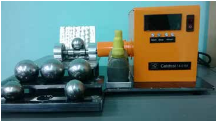
Рисунок 6 – Разработанный нами прибор для испытаний материалов и покрытий на микроабразивный износ
