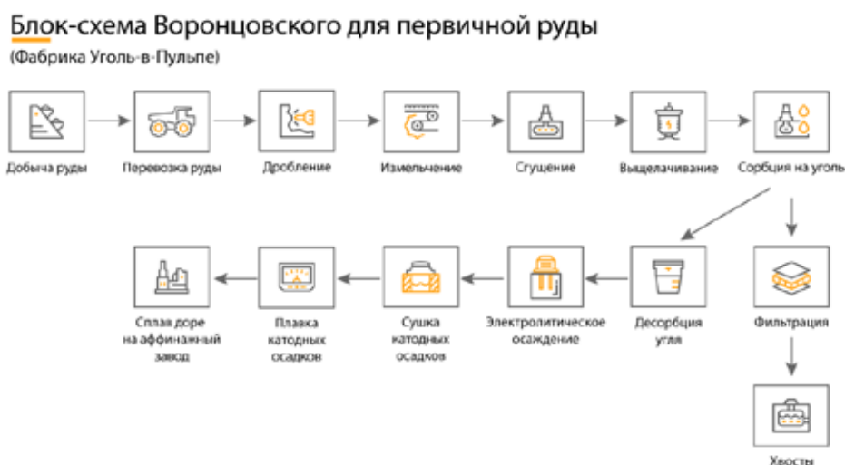
Рис. 1. Блок схема переработки первичных руд Воронцовского месторождения [15]
