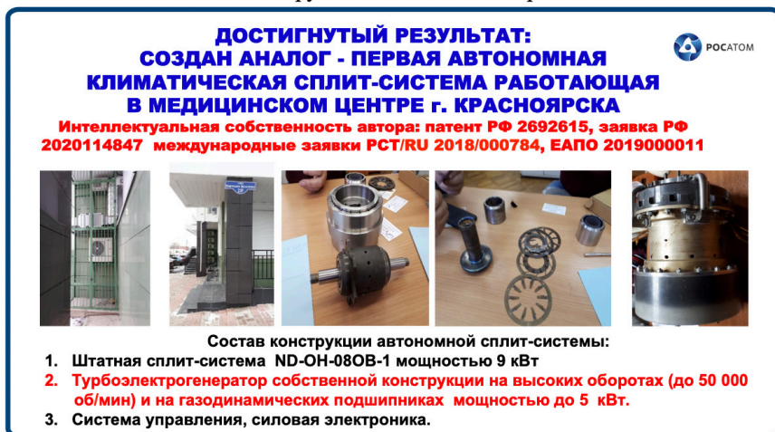
Рис 2. Экспериментальное устройство – автономная климатическая система с генерацией электрической энергии из воздушной среды
