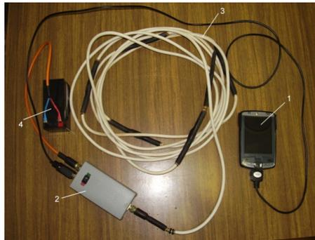
**Рис. 3. Комплекс измерения температуры «Термоскан»: 1- КПК; 2- контроллер, 3-измерительная коса с датчиками температуры, 4-аккумуляторная батарея.**
