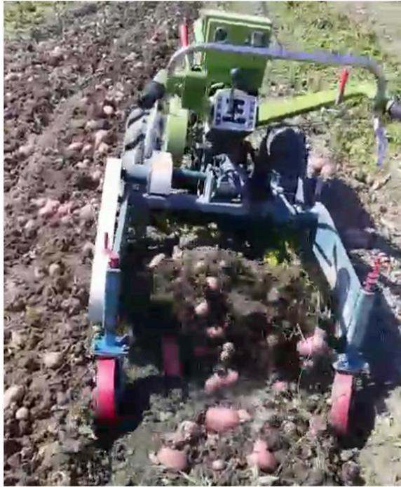
**Рисунок 2 – Вид картофелекопалки в рабочем процессе**
