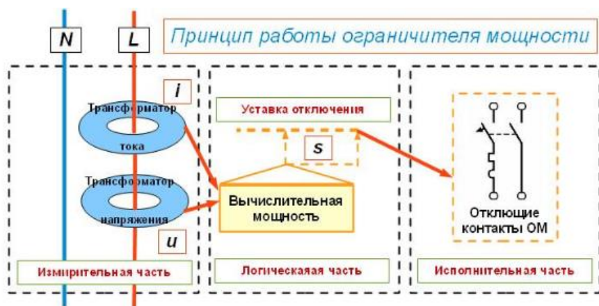
Рисунок 2 - Принцип работы ограничителя мощности
