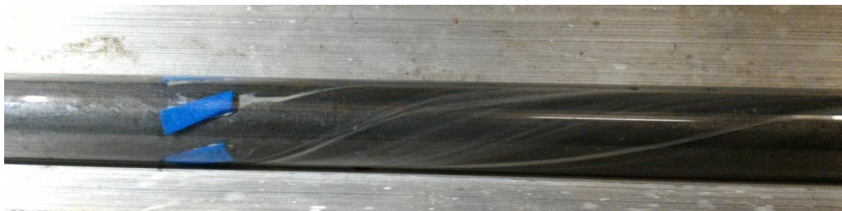
Рисунок 7. Турбулизация потока жидкости после прохождения центратора-турбулизатора.
