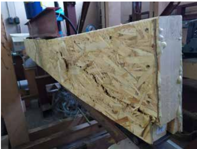
Рисунок 7. Второй образец после разрушения
