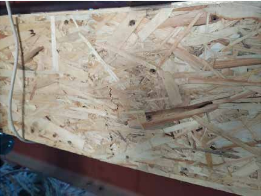
Рисунок 9. Третий образец после разрушения
