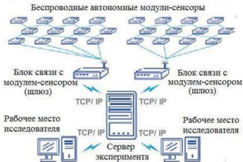
Рисунок 2. Схема функционирования сенсорной сети
