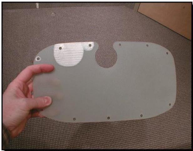
*Рисунок 4. Визуальный контроль расслоения обшивки*
