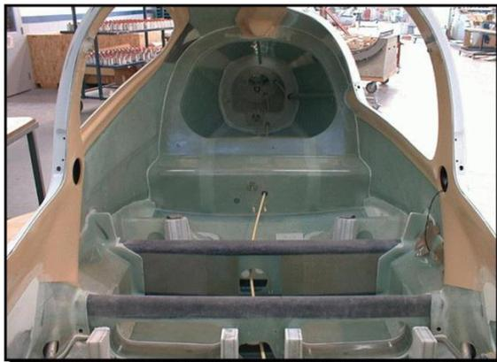
*Рисунок 3. Вид изнутри на центроплан и хвост фюзеляжа*
