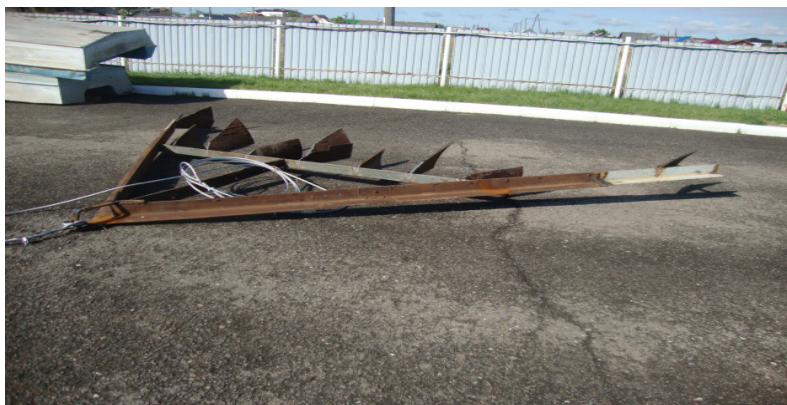
Рисунок 1. Рыхлитель ила конструкции Сладковского рыбхоза. Длина остро отточенной грани агрегата 3 м.
