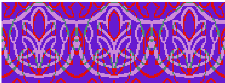
Рисунок 3. Фрагмент технического рисунка двухсторонней жаккардовой ткани двойной ширины
