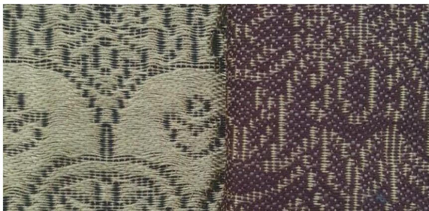
Рисунок 5. Опытный образец двухсторонней жаккардовой ткани двойной ширины
