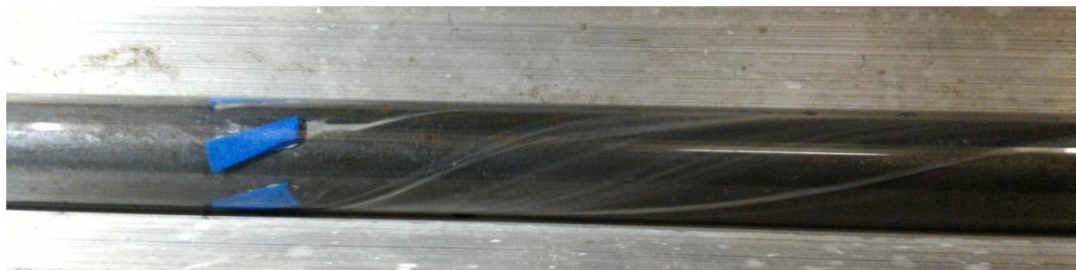
Рисунок 7. Турбулизация потока жидкости после прохождения центрирующего-турбулизатора.
