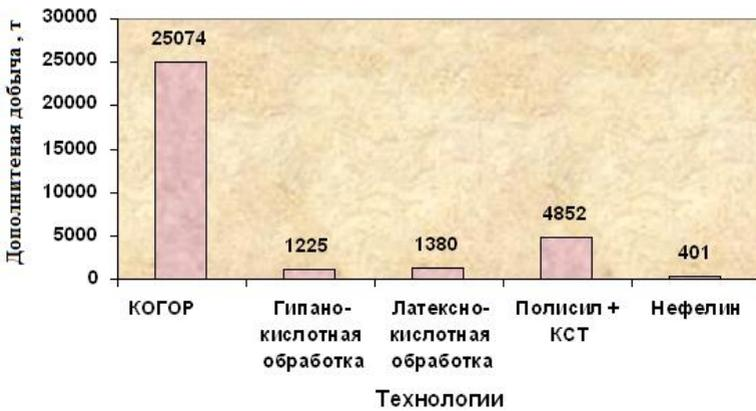
Рисунок 3. Дополнительная добыча за счет внедрения технологий в терригенных коллекторах
