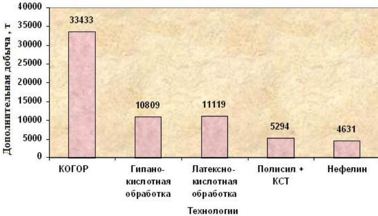
Рисунок 2. Общая дополнительная добыча за счет внедрения технологий
