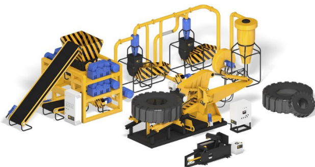
Рисунок 3. Комплекс оборудования для переработки шин в резиновую крошку Auto Tire Recycling King (Globalplant)
