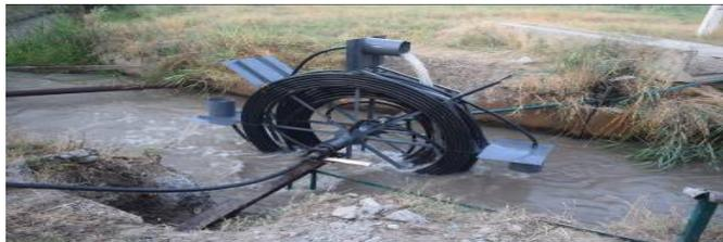
Водоподъемное устройство в виде спирали Архимеда, которое мы рекомендуем к использованию. Он может поднять 50 тонн воды в сутки на высоту 8 м за счет кинетической энергии водного потока.
