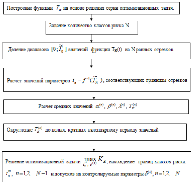
Рисунок 4. Блок-схема формирования классов риска и параметров контроля для каждого класса риска
