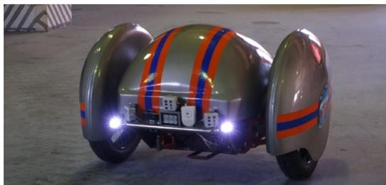
Рисунок 3. Высокомобильный статически уравновешенный автономный модуль мультиагентного робота-разведчика на одноосном шасси для МЧС РФ
