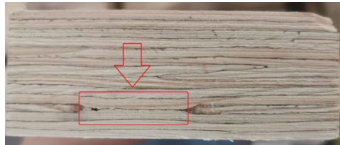
Рисунок 2. Пример прерывания слоя LVL-бруса
