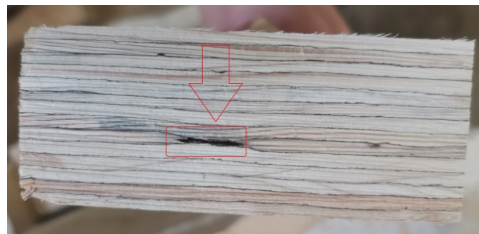
Рисунок 3. Пример LVL-бруса с отверстием
