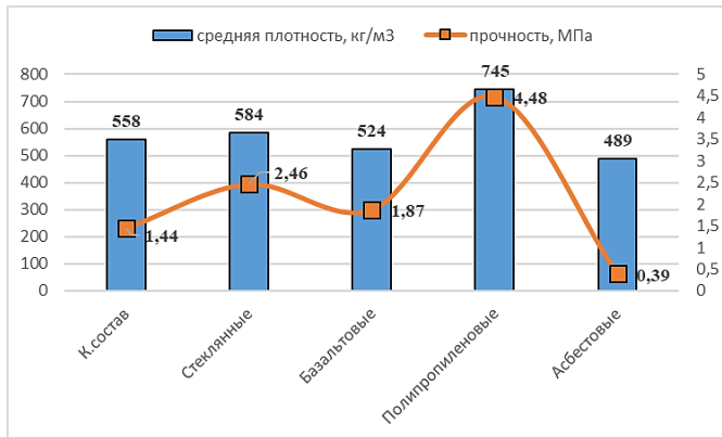
Рисунок 2. Влияние вида фибры на свойства пенобетона FoamCem
