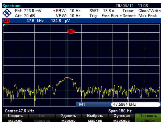
Рисунок 2. Показания анализатора спектра для Rohde&Schwarz - R562A при сигналах акустической эмиссии, увеличенных эффектом Горбунова (ультразвуком частоты 47,59 КГц).
