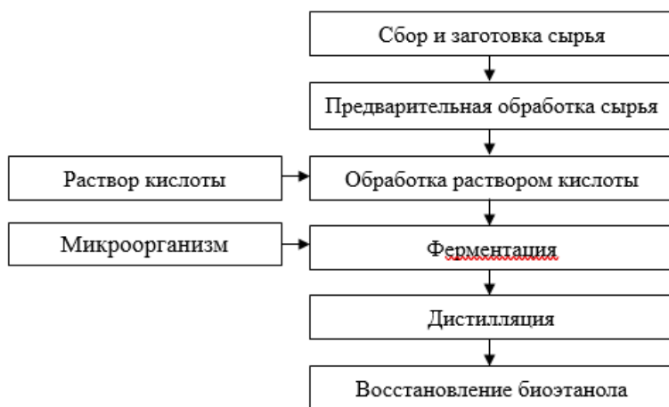
Рисунок 1. Технологическая схема получения биоэтанола из биомассы водяного гиацинта
