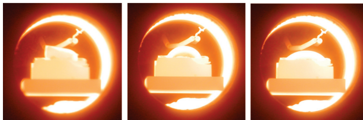
Рисунок 3. Фотографии смачивающих капле кремния на подложке квази-монокристалла
