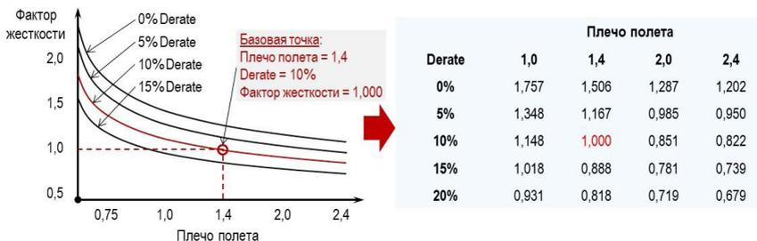
**Рисунок 3.** Пример определения факторов жесткости эксплуатации двигателя
