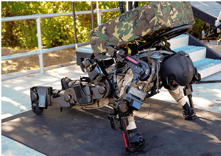
*Рисунок 2. Экзоскелет для пожарно-спасательных*
