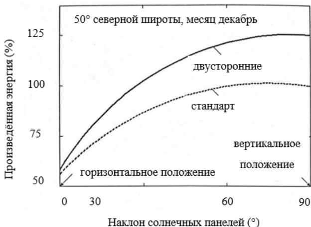
**Рисунок 1.** Количество производимой энергии в зависимости от угла наклона установки солнечных фотоэлектрических модулей [26]
