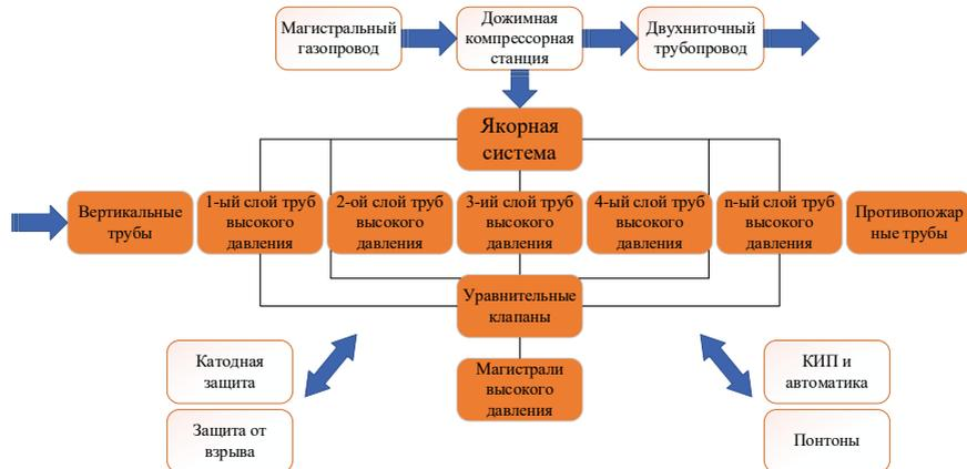
Рисунок 2. Схема устройства хранилища.
