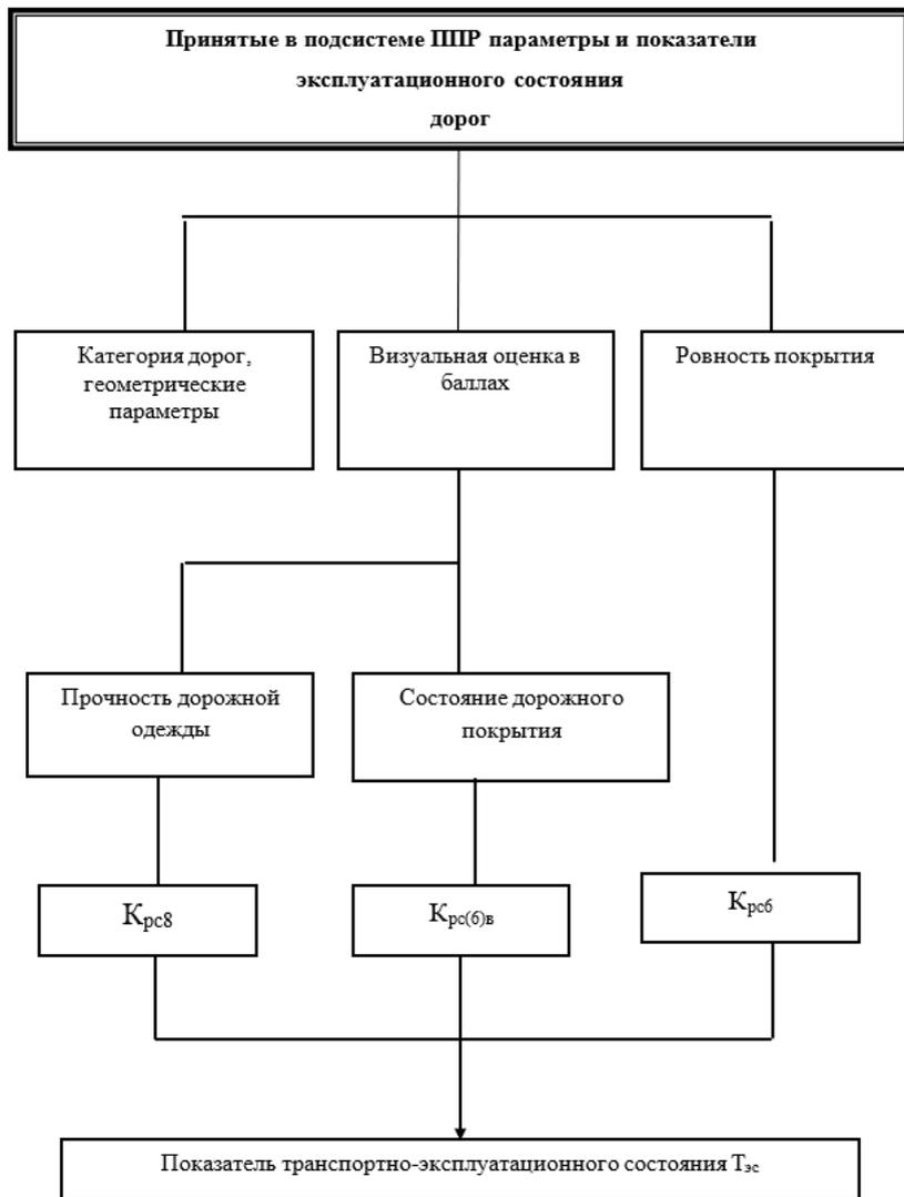
*Рисунок 1. Структурная схема оценки эксплуатационного состояния дорог для реализации модели планирования дорожно-ремонтных работ в подсистеме ППР.*
