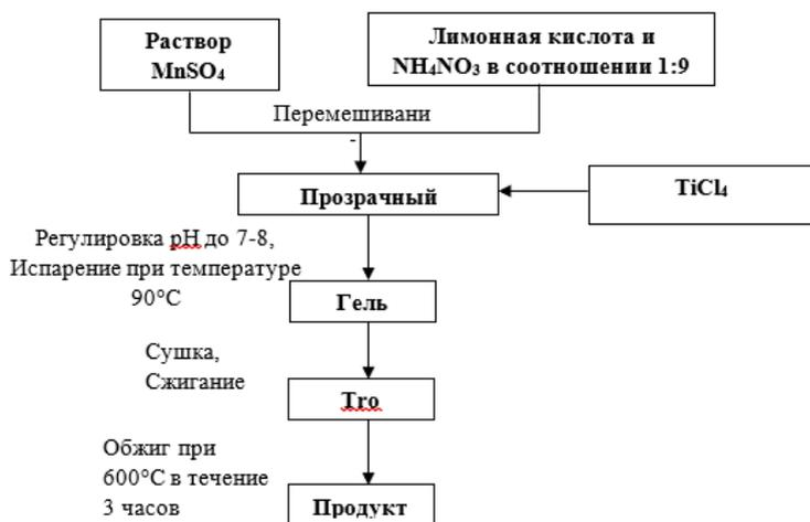
Рисунок 1. Блок-схема синтеза  $TiO_2$  с использованием цитратного золь-гель метода.
