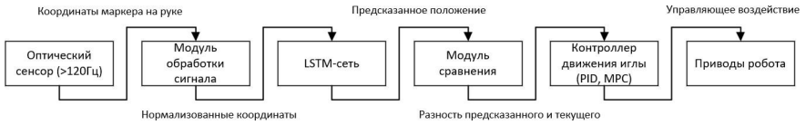
Рисунок 7. Примерная структура интеграции LSTM
