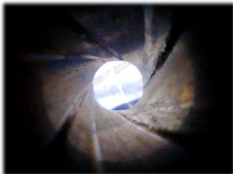
Рисунок 1. Вид канала ствола после стрельбы стандартными боеприпасами.
