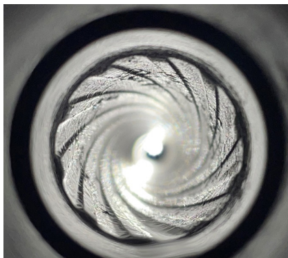
Рисунок 5. Вид канала ствола АМ-23 после стрельбы
