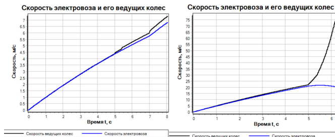
Рисунок 6. График скорости при задании M = 3 \text{ Нм} (слева) и при M = 13 \text{ Нм} (справа)
