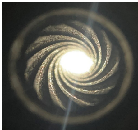
Рисунок 4. Вид канала ствола АМ-23 до стрельбы
