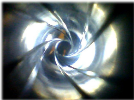
Рисунок 3. Вид канала ствола после последующего выстрела стандартным боеприпасом.
