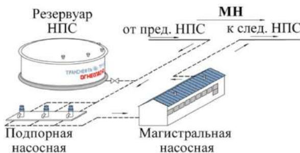
Рисунок 3. Принципиальная схема технологического процесса на НПС
