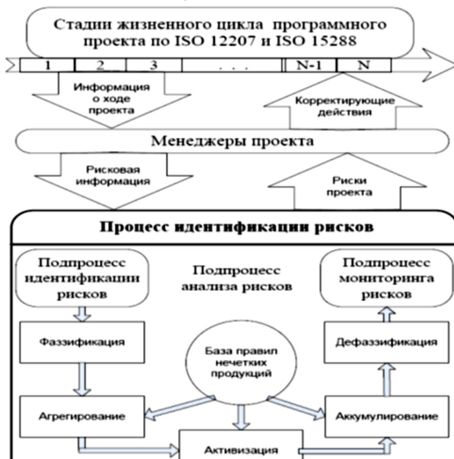
Рис. 1. Структура процесса идентификации и анализа проектных рисков на основе нечетких сетей Петри
