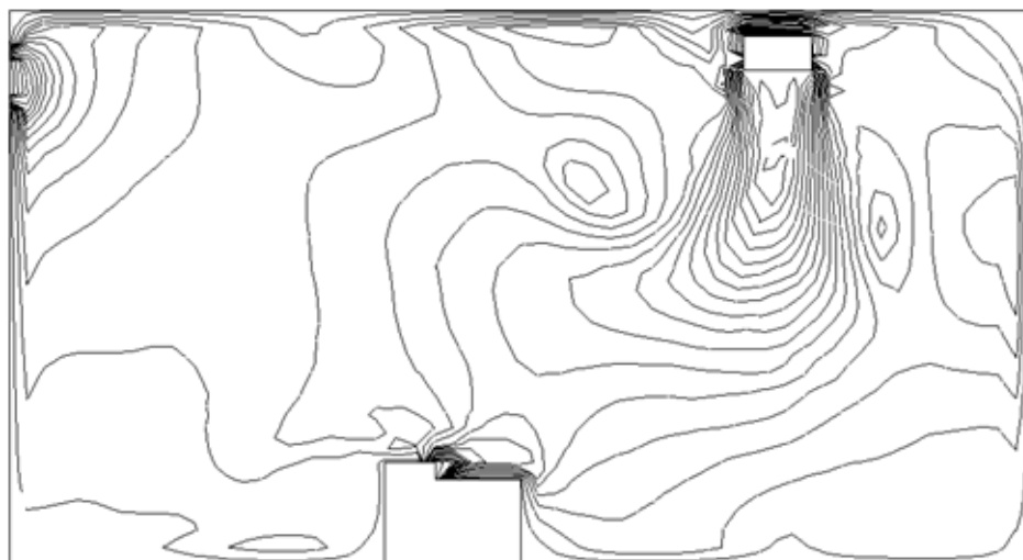
Рисунок 3 - Распределение скоростей воздушных потоков при действующей вентиляции: t_p=45^\circ\text{C} ; k_p=3\text{ ч}^{-1}
