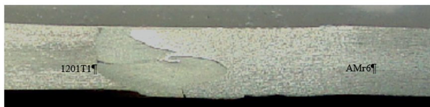
Рис. 6. Макроструктура соединения СТП сплавов АМг6 + 1201Т1 (x100 Образцы после сварки подвергались анодированию)
