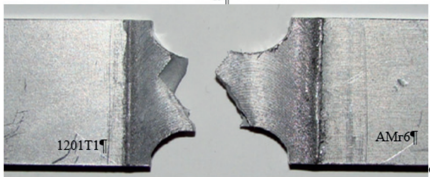
Рис. 5. Разрушение образцов сварных соединений сплавов АМг6 и 1201Т1 после испытания на прочность металла шва с обратной (а) и лицевой (б) стороны
