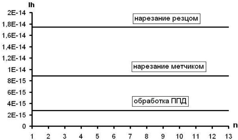
Рис. 2. Сравнительный расчет интенсивности изнашивания витков резьбы, полученной различными методами в период нормального изнашивания
